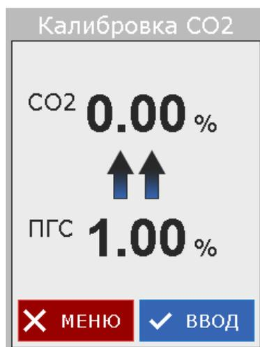
Сверху отображается текущий результат измерения концентрации, а ниже - введенное ранее значение ПГС. При помощи кнопок «◀|» и «|▶» можно установить значение используемой ПГС. Подать ПГС с введенным в прибор значением в соответствии с пунктом 3.3.1 данного руководства. Наблюдая за значением сверху, дождаться установления стабильных показаний и нажать кнопку «ВВОД».
