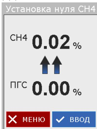
Сверху отображается измеренное значение концентрации метана. Для установки нуля дождаться установления показаний и нажать кнопку «ВВОД». В случае успешной установки в нижней части индикатора появится надпись: «Выполнено!». Для выхода из этого режима без проведения установки нуля необходимо нажать кнопку «МЕНЮ».
