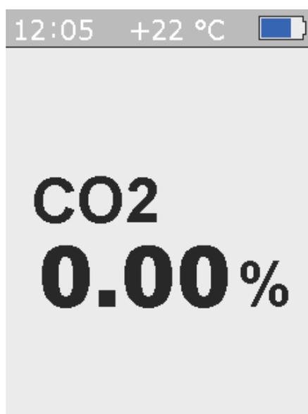
Для выхода из этого режима нажать кнопку ВВОД. Также прибор автоматически выходит из этого режима по истечении двух минут.
