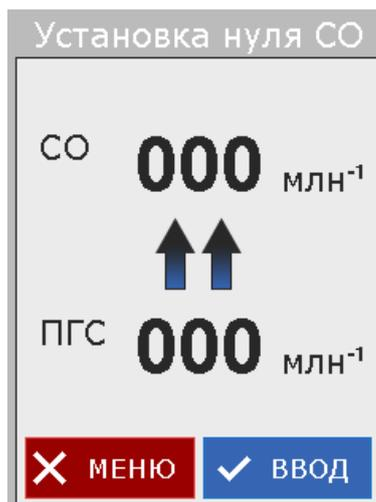
Сверху отображается измеренное значение концентрации СО. Для установки нуля дождаться установления показаний и нажать кнопку «ВВОД». В случае успешной установки в нижней части индикатора появится надпись: «Выполнено!». Для выхода из этого режима без проведения установки нуля необходимо нажать кнопку «МЕНЮ».
