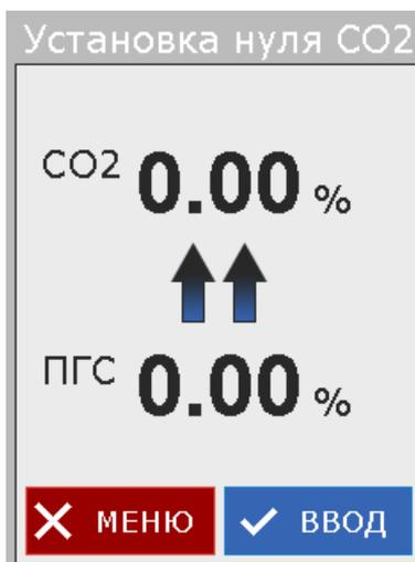
Сверху отображается измеренное значение концентрации СО<sub>2</sub>. Для установки нуля дождаться установления показаний и нажать кнопку «ВВОД». В случае успешной установки в нижней части индикатора появится надпись: «Выполнено!». Для выхода из этого режима без проведения установки нуля необходимо нажать кнопку «МЕНЮ».
