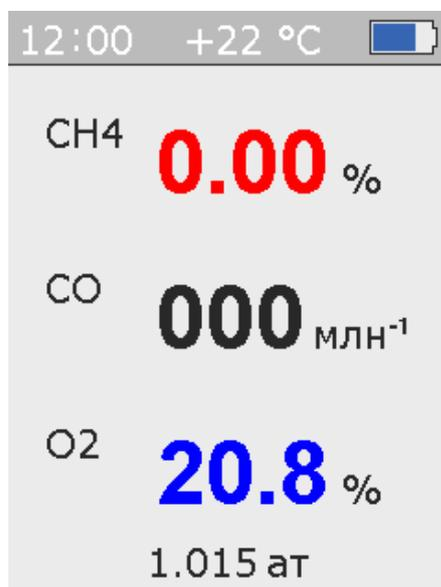
Для модификаций более чем с одним газом возможно переключение между режимами отображения одного или нескольких газов. В этом случае крупным шрифтом отображается концентрация одного из газов, а мелким - остальных. Для переключения режима необходимо нажать и удерживать одну из кнопок «◀|» и «|▶» до момента переключения в следующий режим.
